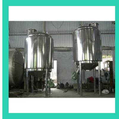
10 KL Storage Tank
